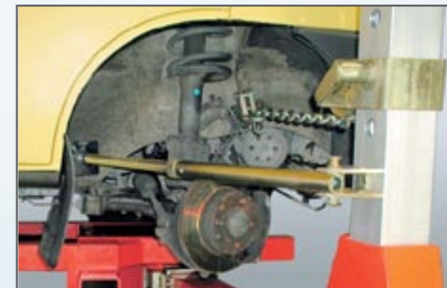
B20:n veto/työntö-oikaisupuomi sisältää säädettävän tuentavarren, joka asennetaan runkorakenteen taitumakohtaan puomin hydraulikan avulla.
