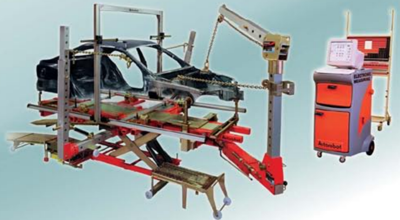
Kuvassa B20 Gold-setti sekä mekaaninen/elektroninen mittalaite
