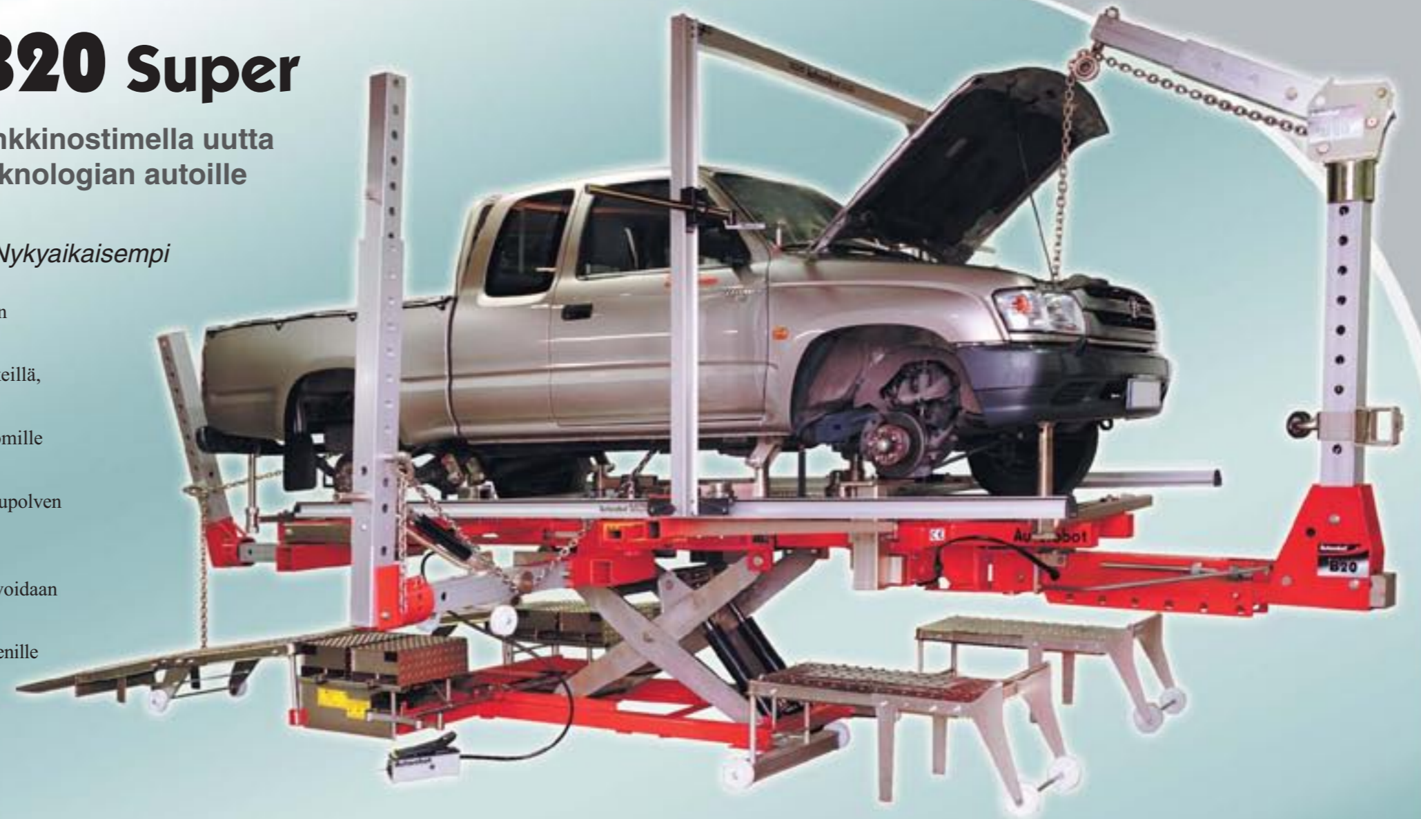
Kuvassa B20 Gold-setti ja Starblock kiinnityssarja, kiinnityssarja Pick-ueille ja mekaaninen/elektroninen mittalaite
